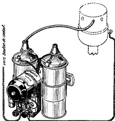
**Le DISPOSITIF** complet avec deux bobines et deux condensateurs.....
