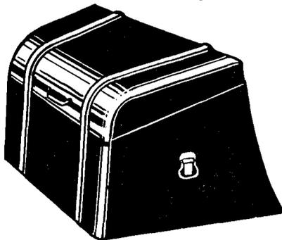
*La FIXATION se fait par deux TENDEURS de côté.*
