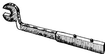
*pour le serrage des écrous de culasse*
