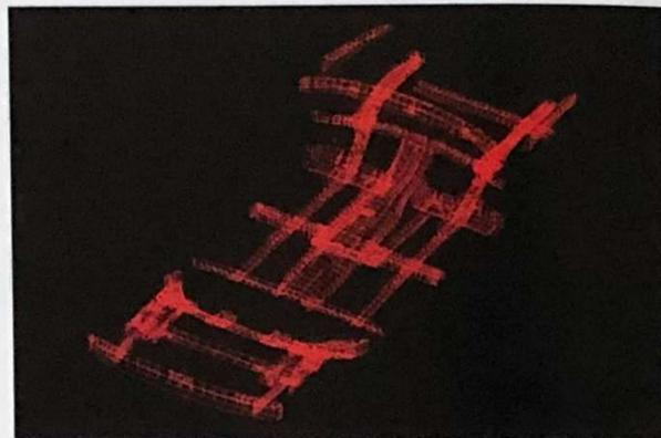
La plate-forme de conception nouvelle est renforcée par de nombreuses poutres transversales et longitudinales. Le tunnel de passage de l'échappement est doublé par une tôle monopiece sur toute sa longueur.
