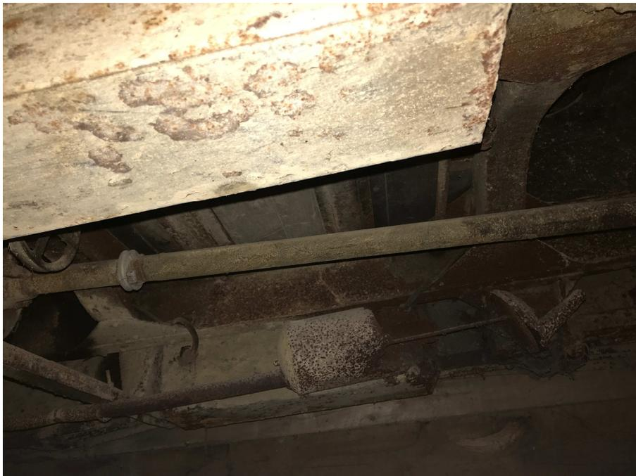
L'ensemble du châssis présente une oxydation de surface. l'ensemble a été préservé du fait de la qualité du lieu de garage du véhicule
