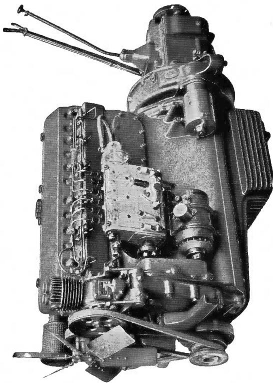
**CHASSIS :** Moteur diesel 6 cylindres  $94 \times 110$ , cylindrée 4,580 L, puissance effective 76 cv à 2.500 tours-minute, puissance fiscale 12 cv. Cylindres avec chemises en fonte spéciale emmanchées à force. Soupapes en tête. Alimentation par pompe d'injection. Boîte de vitesses à 4 vitesses et une marche arrière ; les 3<sup>e</sup> et 4<sup>e</sup> sont synchronisées et à denture silencieuse.
