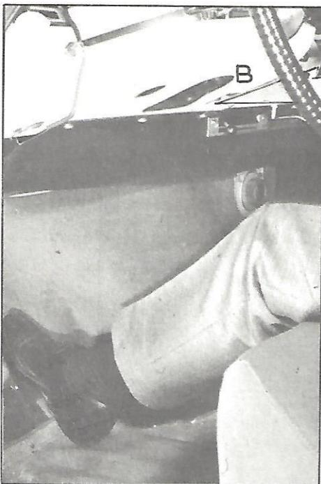
Ensuite, moteur à l'arrêt, faites tomber la pression dans le cylindre de débrayage à l'aide de la commande manuelle d'embrayage (flèche B).
